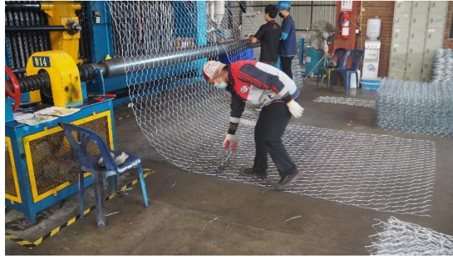
ภาพ 4.3 การตรวจสอบความยาวของลวดถัก
