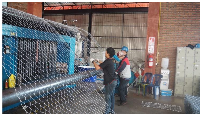
ภาพ 4.4 การตัดลวดถักเมื่อถึงระยะ
